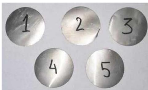
Рис. 10. Мембраны для контрольного испытания
