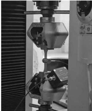
Рис. 8. Испытание образца на растяжение с АЭ
